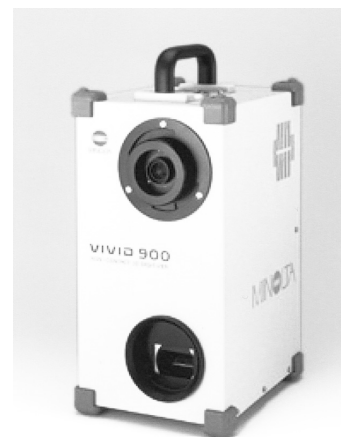
図1 本実験に用いた非接触型3次元形状計測装置 VIVID900
